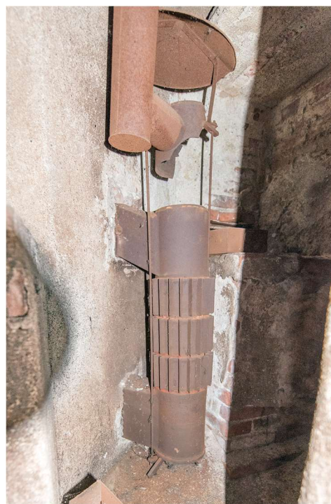
Obr. 40: Topidlo v topeništi sirné komory ve skladu čp. 1232 (pasport č. 28).
